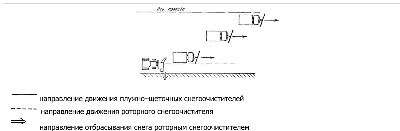
Рисунок 2.5 – Схема расчистки проезжей части улиц колонной плужно-щеточных снегоочистителей и перекидывание снега роторным снегоочистителем
