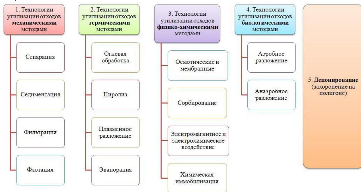
Рисунок 4.1. — Принципиальная схема-классификация известных технологий утилизации и обезвреживания опасных отходов производства и потребления [6]
