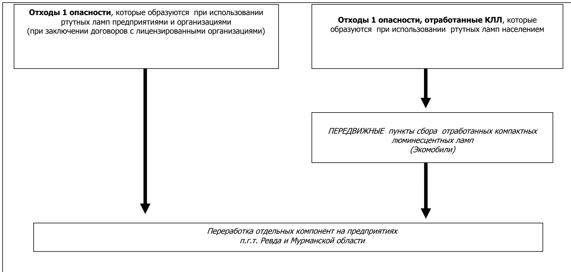
Рисунок 4.7. — Функциональная блок-схема движения потока опасных отходов от отработанных ртутьсодержащих ламп при наличии ПЕРЕДВИЖНЫХ пунктов сбора отработанных КЛЛ
